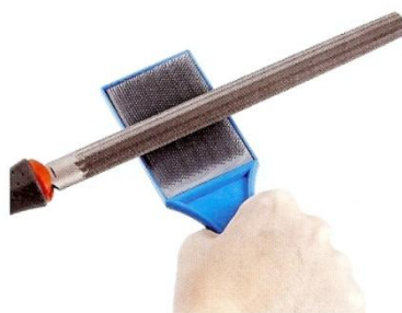
▶ Limpieza de una lima con una carda.
