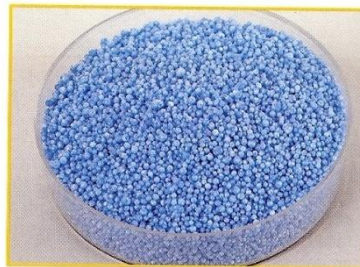
▶ Los plásticos se comercializan en forma de polvo, gránulos, trozos, espumas, láminas, etc.
